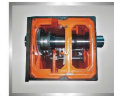
Spindle 4-steps speed auto. Change 主轴四段自动变速
